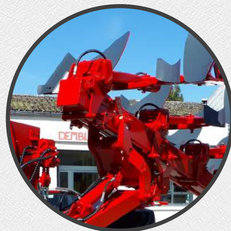
Solide structure mécanosoudée Poutre THLE 200x200
