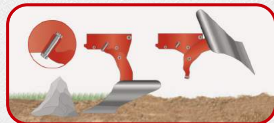
ÉLONGATION - RUPTURE DU BOULON
