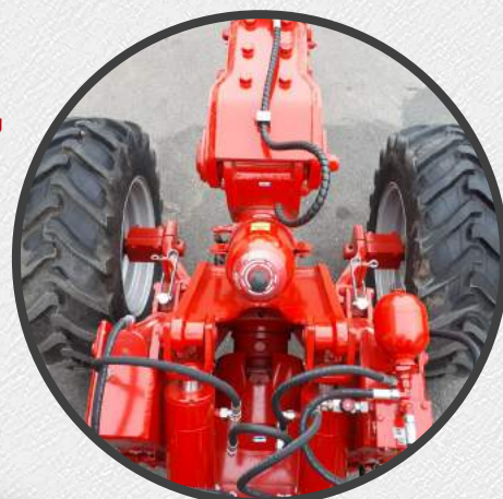
L'articulation du châssis est permise par un cardan surdimensionné, placé au niveau du chariot.
