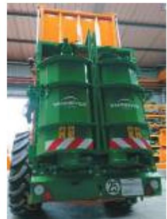
Pour une polyvalence maximale de votre épandeur à vis verticales, hotte intégrale hydraulique pour compost et fientes
