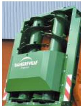
Polyvalence : demi-hotte mécanique pour épandeur à vis verticales
