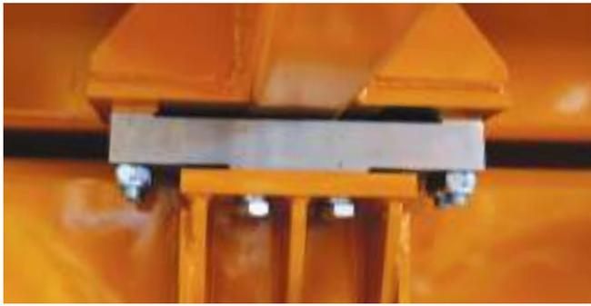
Pesée dynamique avec correction pondérale : elle permet de connaître le poids à tout moment et d'automatiser la régulation du tapis. L'épandeur comprend cinq ou six capteurs.
